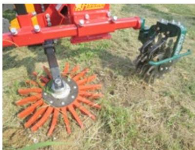
può verificare l'accumulo di erbe sul rotore che va pulito dall'operatore per non inficiare la qualità del lavoro.
